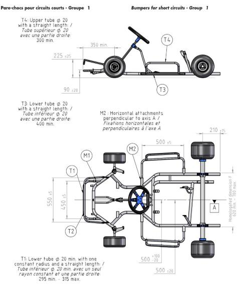
T2: Upper tube Ø 16 min. with one constant radius and a straight length: / Tube supérieur Ø 16 min. avec un seul rayon constant et une partie droite: 375 min. – 395 max. M1 : Lower attachments horizontal and parallel to axis A *Fixations inférieures horizontales et parallèles à l'axe A*
