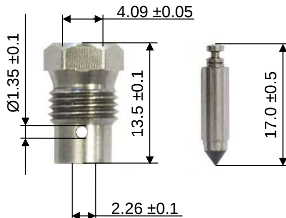
REF.39 - P. N° 43-1035 NEEDLE HIGH SPEED VIS DE RÉGLAGE HAUT-REGIME
